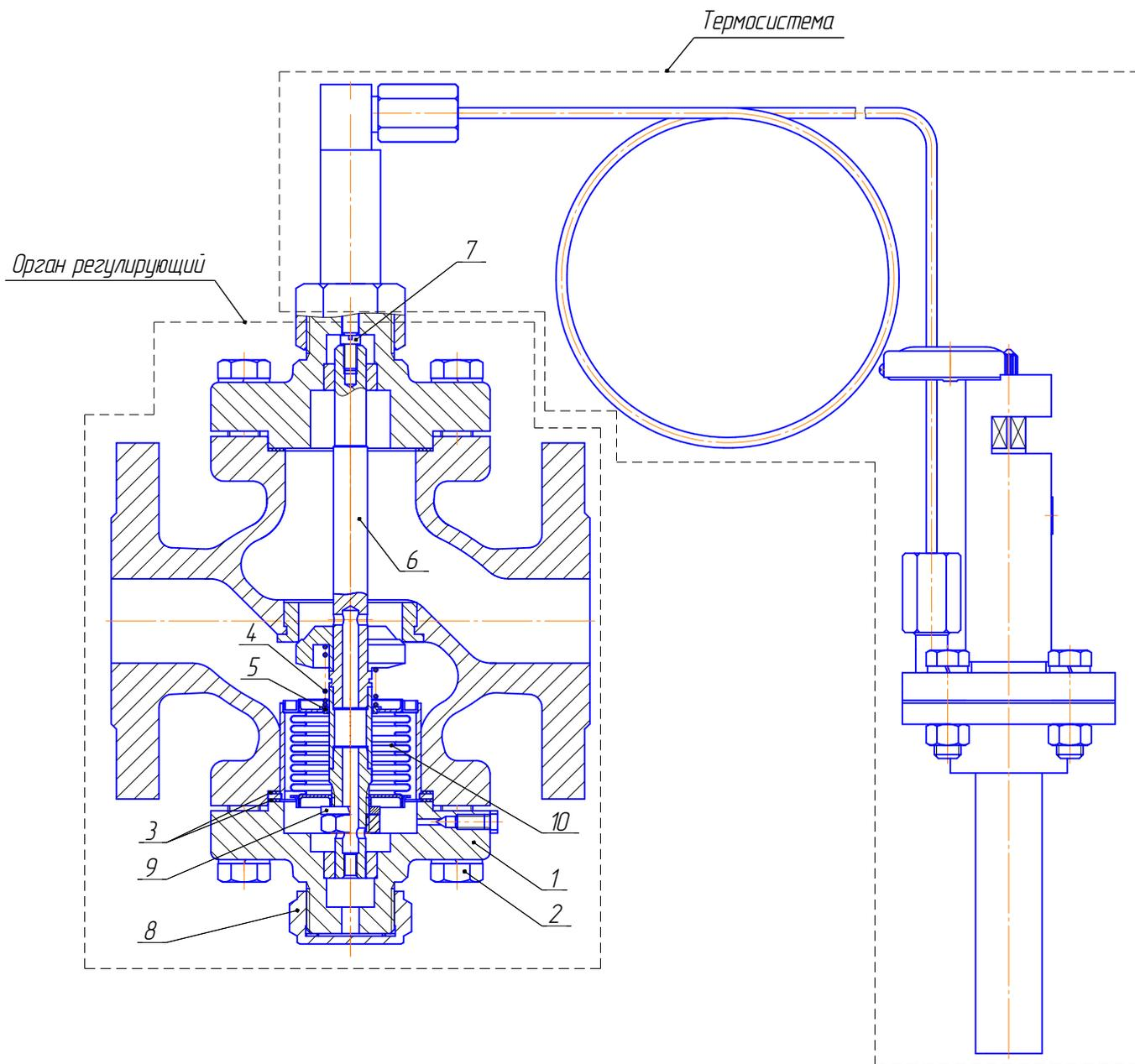
Рис. 2 Регуляторы температуры РТ-ДЗ DN 25-80
